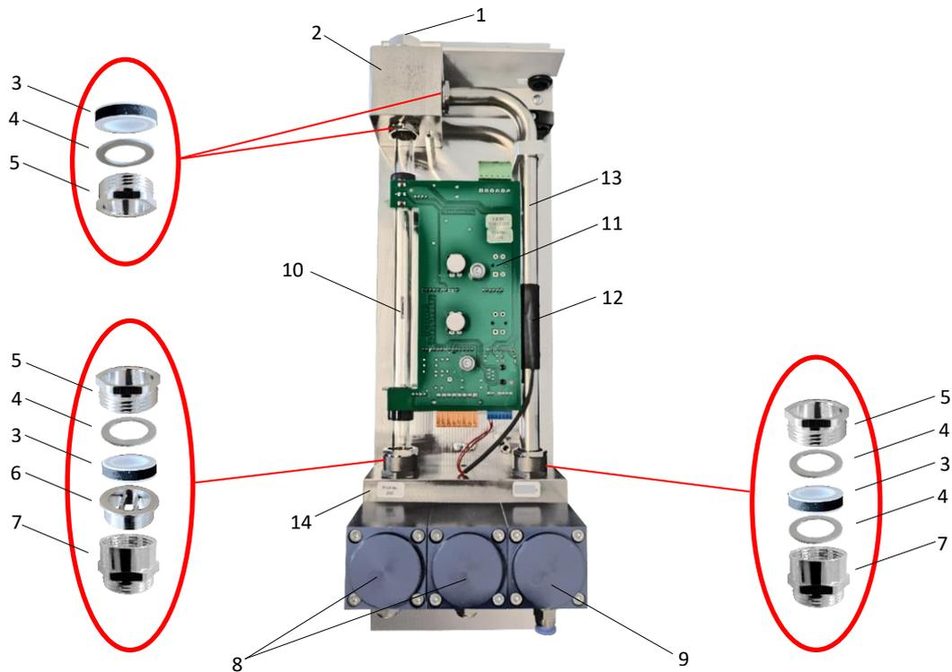
Bild: Messeinheit Z3570A
