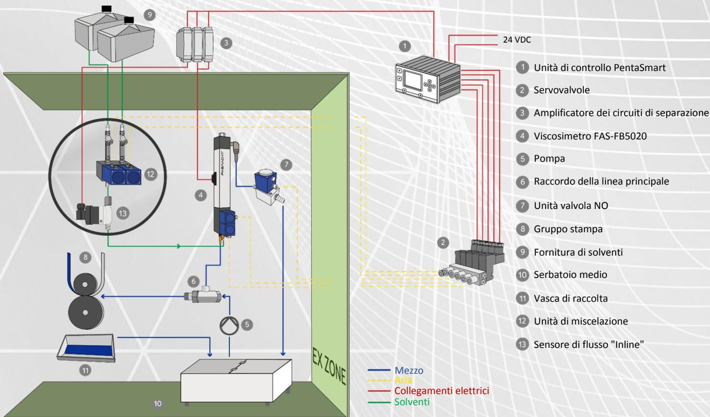
(Fig. Sistema di controllo della viscosità S6-FB con opzione di miscelazione per 2 solventi)
